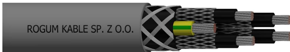
**Экранированный сигнальный кабель для горнодобывающей промышленности с полиэтиленовой изоляцией, внутренней оболочкой из ПВХ и внешней оболочкой из ПВХ, не распространяющей горение, на номинальное напряжение 150/250 В, 300/500 В или 0,6/1 кВ. Многопроводный кабель с индивидуальными экранами на проводах и общим экраном на внутренней оболочке.**
